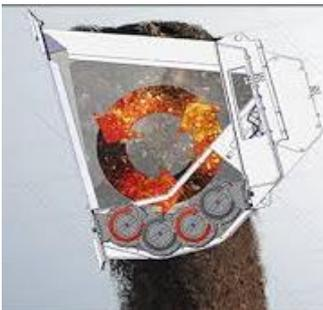
Die Wellen sind in einem speziellen Winkel in der Maschine angeordnet und bilden einen Bogen wodurch das Material in eine Drehbewegung gerät. Somit wird ein hoher Durchsatz auch bei nasser und bindiger Erde erreicht.
